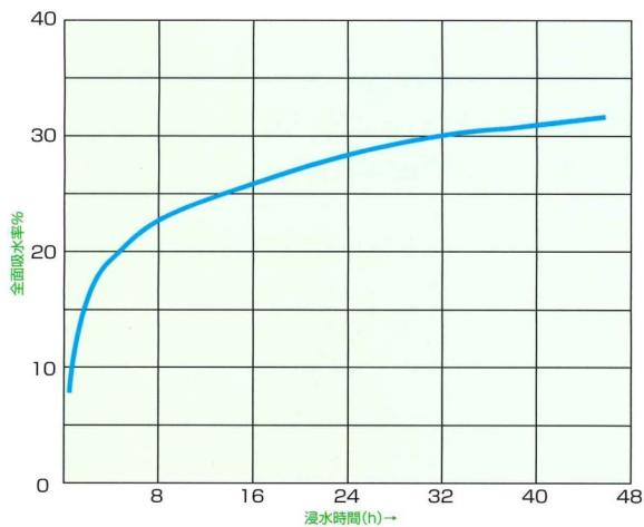
※試験体一辺10cmの立方体を温度70±5°Cの乾燥器中で恒量となるまで乾燥(含水率3%以下)し、室温で冷却する。冷却後清水中に試験体を入れ上面が水面下約3cmになるように沈め、24時間値に取り出し質量を測定する。
